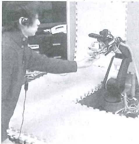
ロボットに物を握らせ、その言葉を教える—電気通信大学提供
